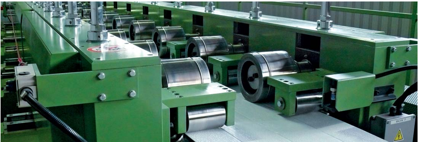
Początek produkcji paneli - kształtowanie blachy
