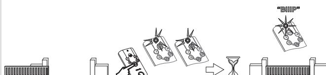
**Mouvement interrompu (Fig. 11)****11**
