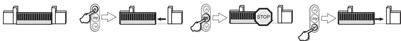
**Funzionamento delle fotocellule di sicurezza**
